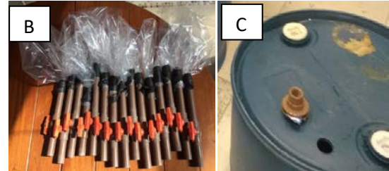
Figura 1: Materiais utilizados na confecção dos seepage meter .
