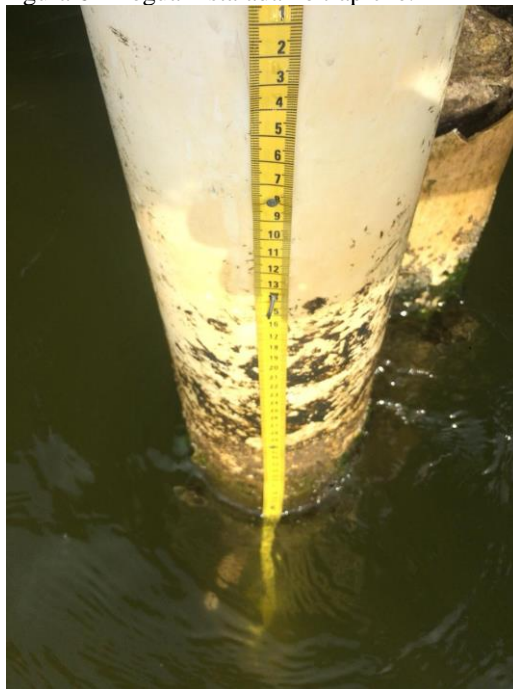
Figura 6 - Régua instalada no trapiche.
