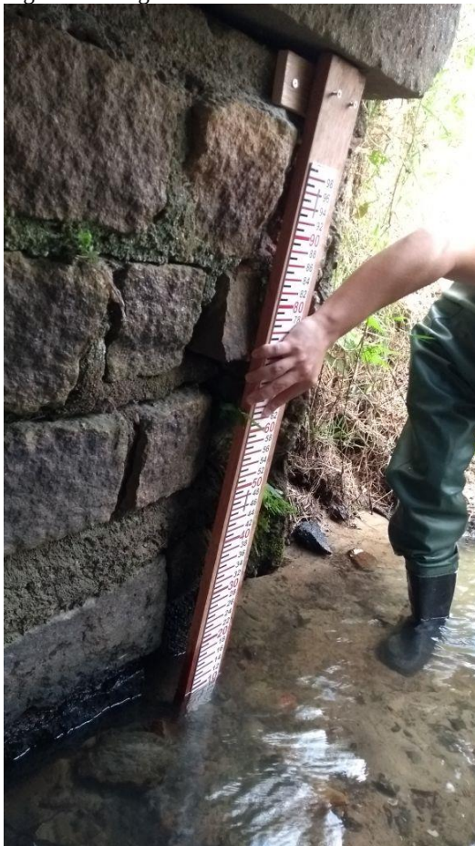
Figura 13 - Régua linimétrica do rio João Gualberto
